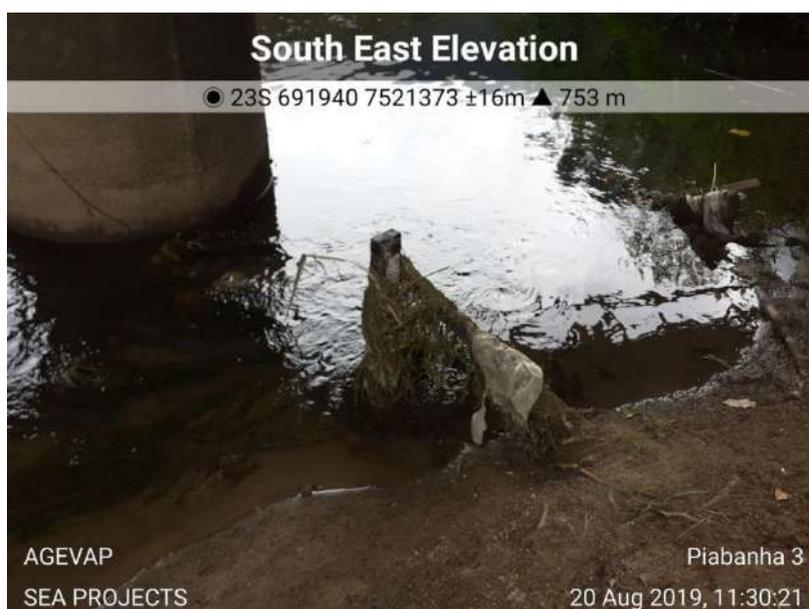
Figura 3.1-12: Régua de nível antes da limpeza.
