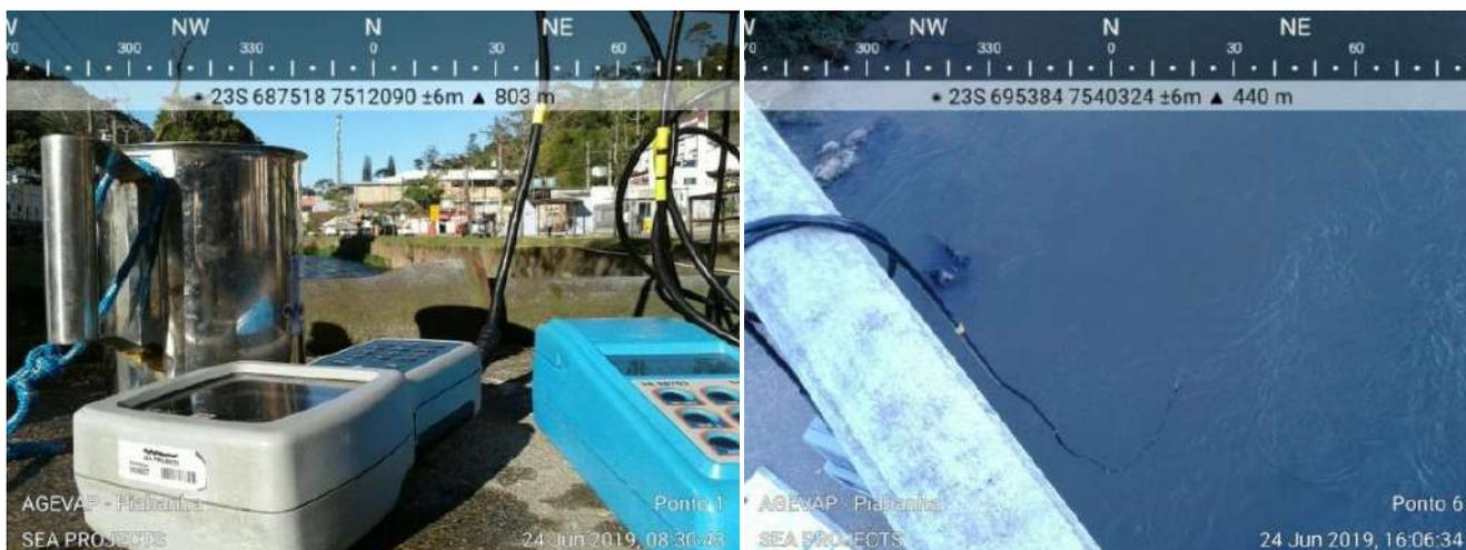
Figura 3.2-1(esquerda): Sonda multiparamétrica e turbidímetro utilizados nas medições de campo.
